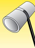
Le tuyau est fixe sur un axe horizontal, soudage en descendante : PG/5G
