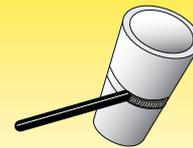
Le tuyau est fixe sur un axe 45°, soudage en montante : H-LO45/6G
