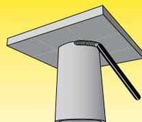
Le tuyau pivote sur un axe vertical, soudage au plafond: PD/4F
