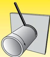
Le tuyau pivote sur un axe horizontal, soudage à plat : PB/2FR
