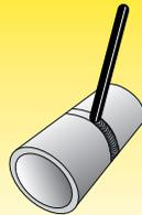
Le tuyau est fixe sur un axe horizontal, soudage en montante : PF/5G
