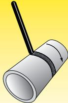
Le tuyau pivote sur un axe horizontal, soudage à plat : PA/1G
