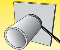
Le tuyau est fixe sur un axe horizontal, soudage en descendante: PJ/5F
